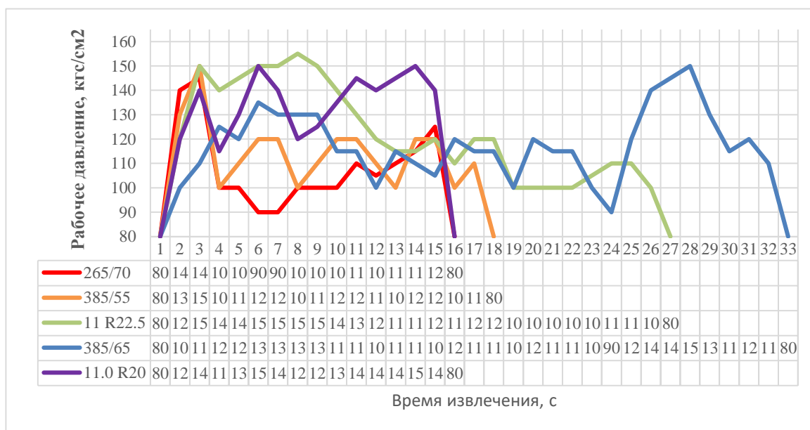
Рисунок 2.21. Диаграммы изменения давления в системе при извлечении бортового кольца из шин 1 группы
