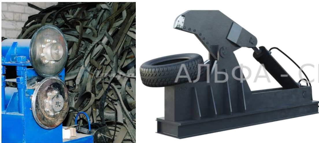
Рисунок 1.5. Оборудования для предварительной разделки шин на части [66, 67]
