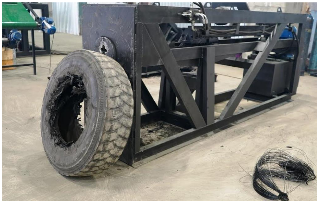
Рисунок 2.11. Общий вид гидравлического станка для удаления бортовых колец
