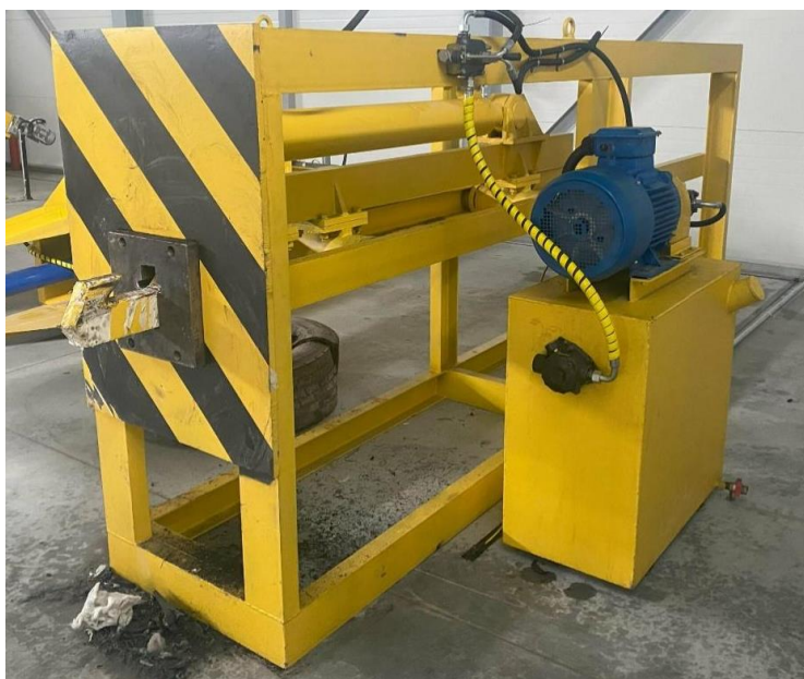
Рисунок 1.11. Гидравлический выдергиватель бортового кольца изношенных шин [86]
