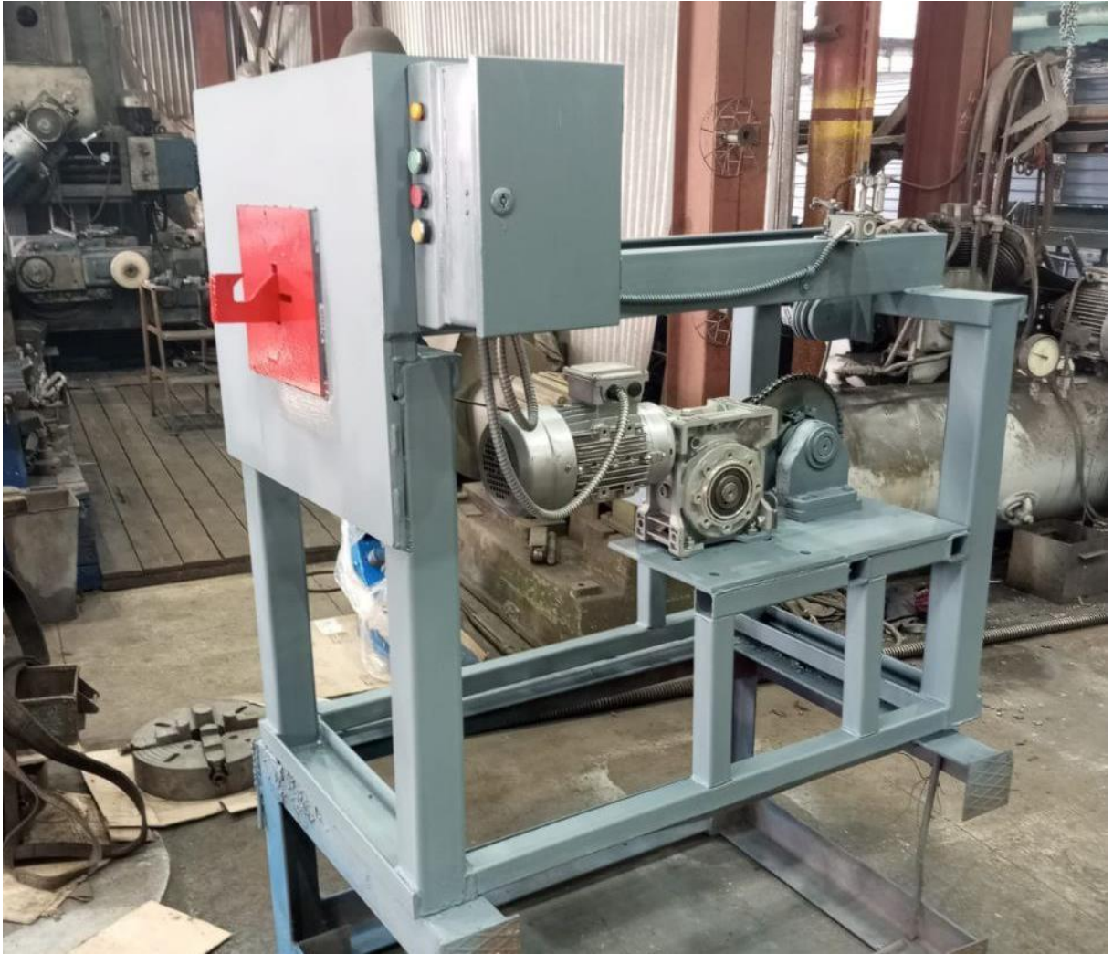
Рисунок 4.6. Установка для извлечения бортовых колец из шин легковых автомобилей
