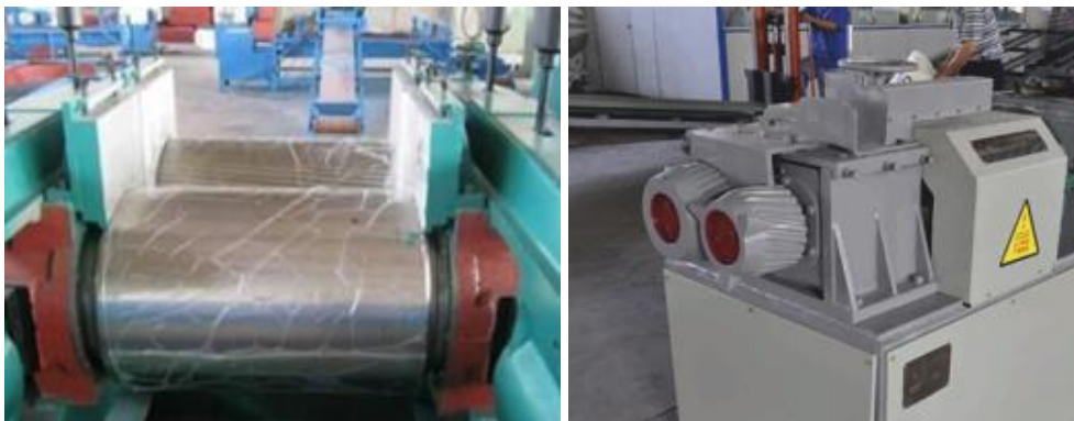
Рисунок 1.6. Оборудование для переработки изношенных покрышек с использованием валков [72]
