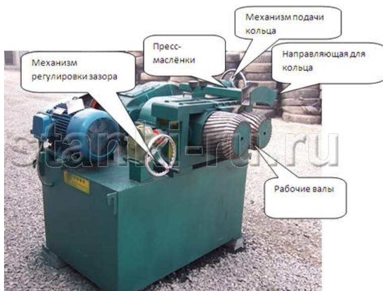
Рисунок 1.9. Оборудование для извлечения бортового кольца при помощи валков [82]
